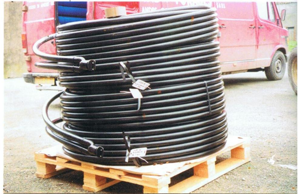
Foto 4.6. Palet con sondas geotérmicas HAKA GERODUR, en forma de simple U, pie de sonda, cubeta de decantación y chapa para colgar el lastre (Fuente: Morand Forages, St André Goule d'Oie, Francia).
