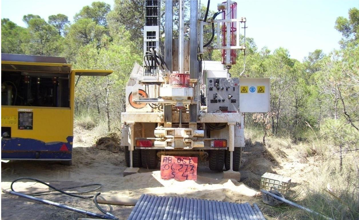
Fuente: Geocesa. Perforaciones a rotación con aire comprimido.
